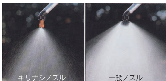
第10図 一般ノズルと飛散低減ノズル(キラナシノズル)の比較例
